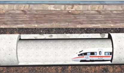
सतह से 33 मीटर नीचे देश का सबसे गहरा मेट्रो स्टॉप होगा, एक बार यह खंड पूरी तरह से चालू हो जाएगा। नदी के नीचे सुरंग पानी की सतह के स्तर से 32 मीटर नीचे है, और मेट्रो को 45 सेकंड में हुगली के नीचे 520 मीटर की दूरी तय करने का अनुमान है। सियालदह और सेक्टर डू स्टेशनों के बीच, ईस्ट-वेस्ट मेट्रो कॉरिडोर जो हावड़ा मैदान और साल्ट लेक सिटी के सूचना प्रौद्योगिकी कोर सेक्टर डू को जोड़ता है, आंशिक रूप से काम कर रहा है। पूर्व-पश्चिम मेट्रो के 16.6 किमी में से 10.8 किमी भूमिगत हैं, हावड़ा मैदान और फूलबगान के बीच हुगली नदी के नीचे यात्रा करते हैं; शेष किलोमीटर एप्लिवेटेड हैं, ईस्ट-वेस्ट मेट्रो कॉरिडोर की ऑपरेटिंग कंपनी के साथ।
